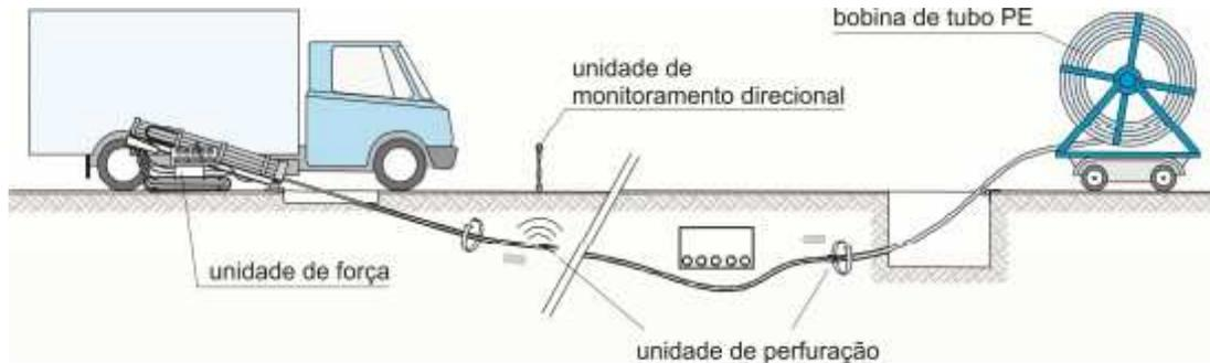
Fig. 1 - Esquema da Operação de Furo Direcional
